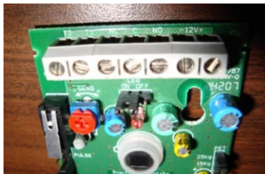
Fig. 9 Borneras del Sensor de Movimiento
