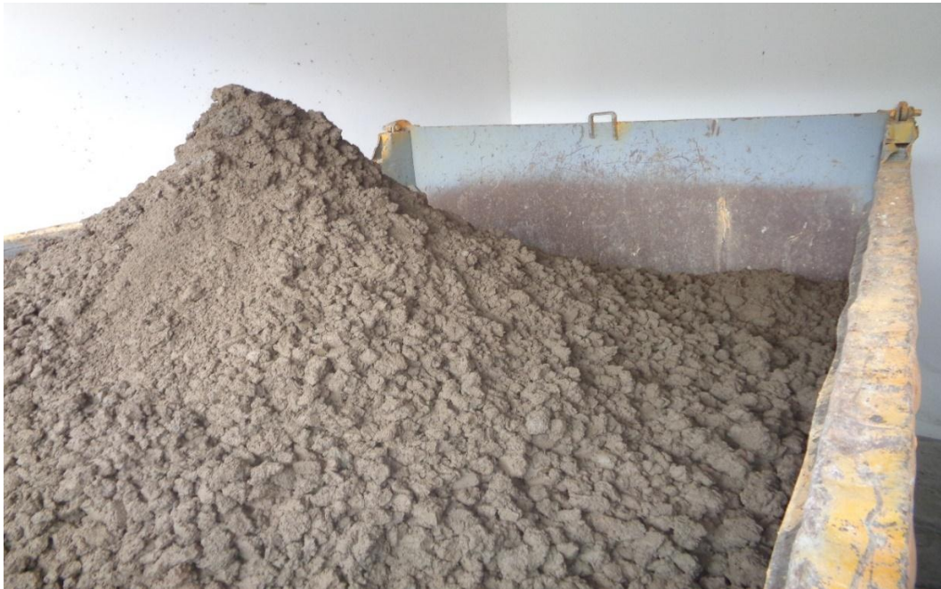
Lodos generados y recopilados en la volqueta para su traslado al Relleno sanitario
