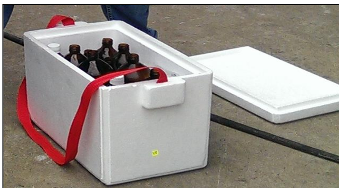
Transporte y preservación de muestras de agua.
