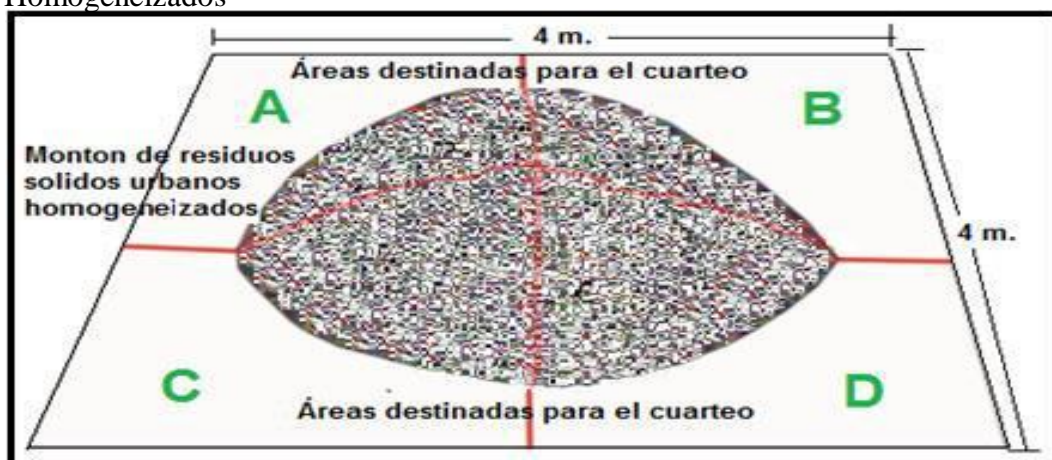
Figura 6. Esquema del método de cuarteo de los Desechos Sólidos Homogeneizados
