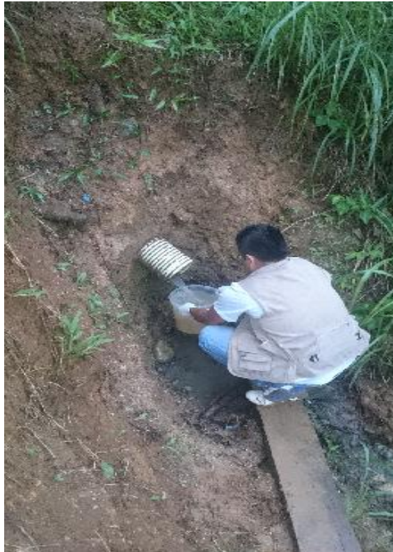
Fotografía 9. Método de medición de caudal.
