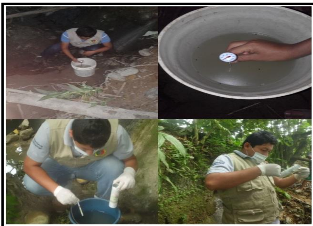
Fotografía 4. Medición de la temperatura y pH del agua residual.
