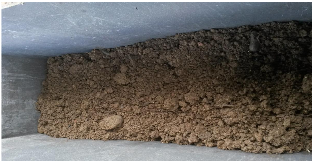
Fotografía 6. Colocación de capa de tierra arcillo-limosa.
