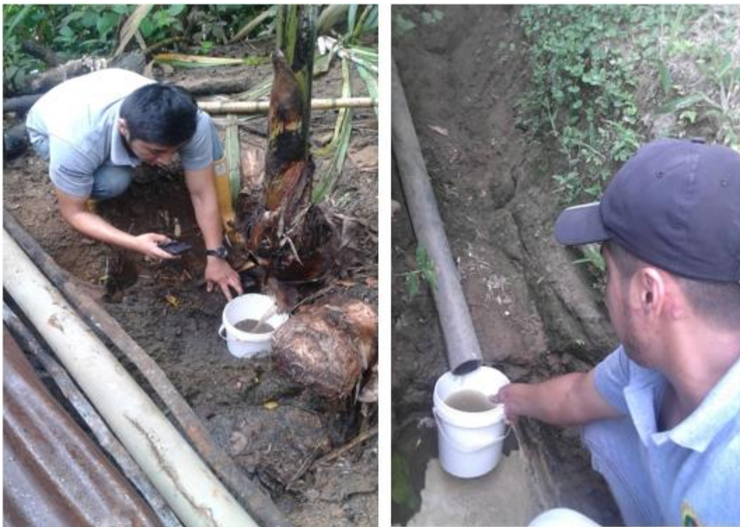
Fotografía 1. Medición del caudal y toma de muestra.
