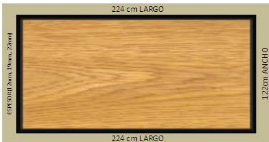
Muestra de tablero aglomerado a base de cascarilla de arroz
