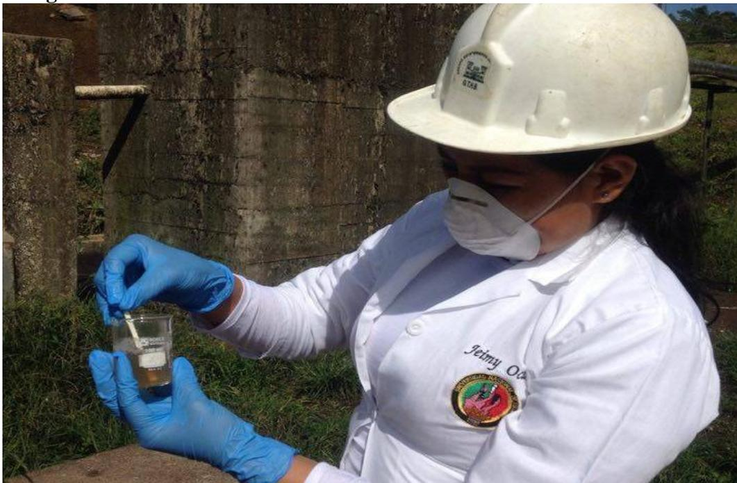
Medición de PH del Agua después de ser utilizada.
