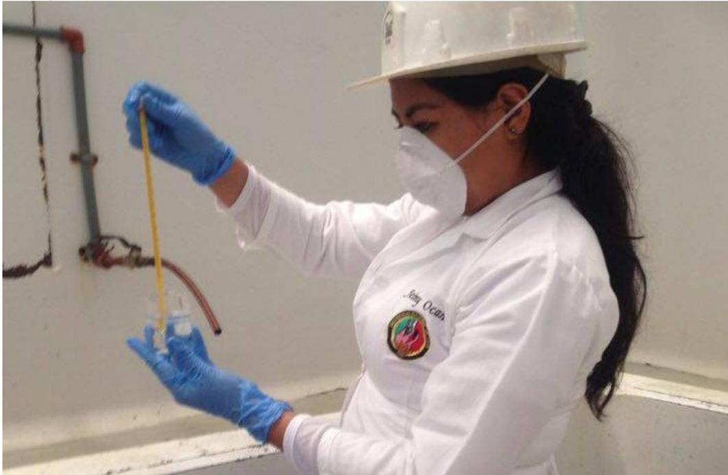
Medición de Temperatura del Agua antes de ser utilizada.
