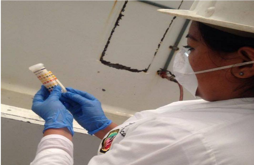
Medición de PH del Agua antes de ser utilizada.
