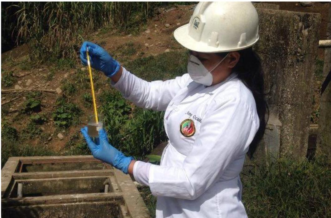
Medición de Temperatura del Agua después de ser utilizada.
