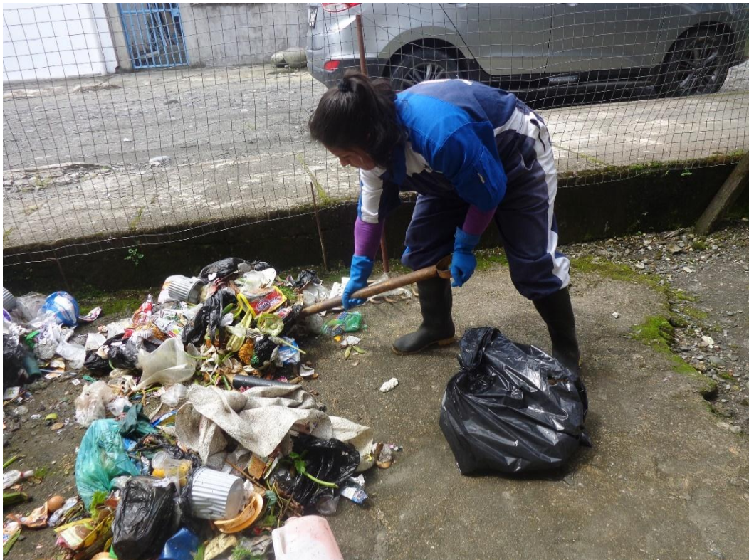
Método del cuarteo de los residuos sólido del barrido de las calles
