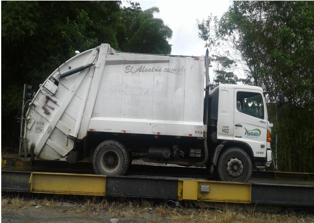
Pesaje del camión recolector en la báscula
