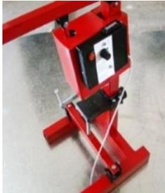
Posee una capacidad máxima de 60cm<sup>3</sup> en el cañón, control de temperatura básico, con voltaje requerido de 110 v-127v, temperatura máxima de 300°C, consumo máximo de 250 w y peso aproximado de 7kg.</p> | Industrias AEL | 450,00 | <b>450,00</b> |
