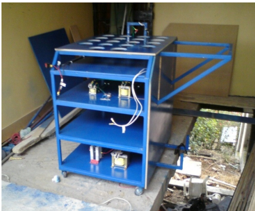
Fig. 3.7 Proceso de conexión eléctrica en el equipo de galvanotecnia
