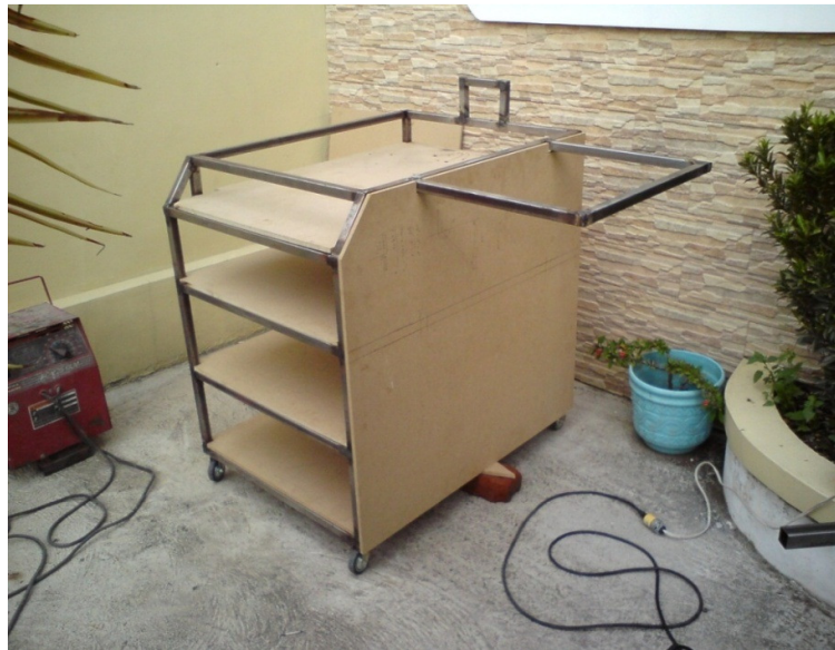
Fig. 3.5 Cubierta de la estructura metálica en madera
