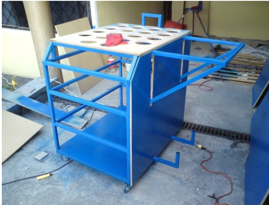
Fig. 3.6 Proceso de aplicación de pintura y sellador a la carcasa del equipo de galvanotecnia
