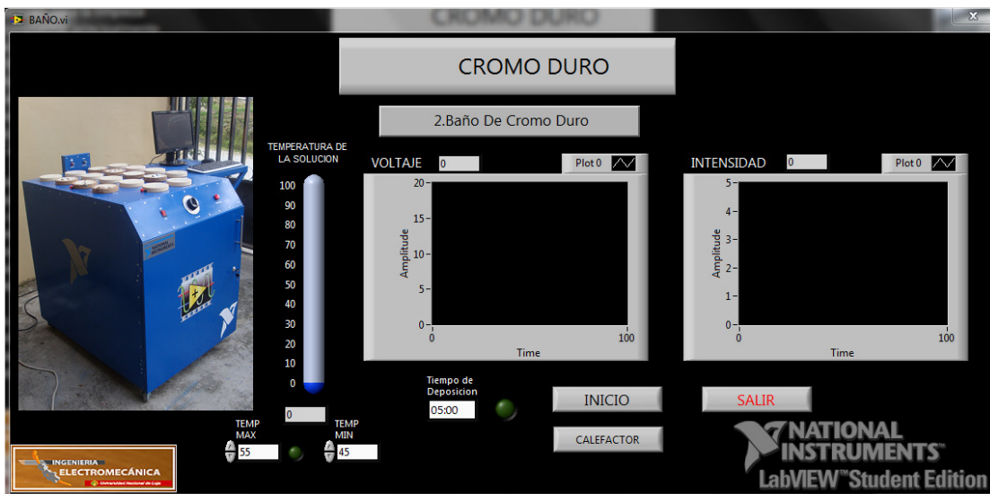
Fig. 2.22 Panel de visualización del proceso de deposición de níquel y cromo duro.
