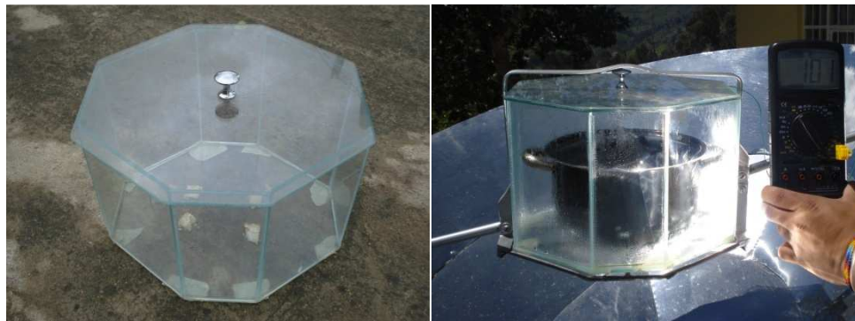
Figura 4.30: Montaje del cobertor de vidrio
