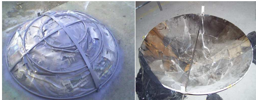
Figura 4.17: Espejo parabólico y su estructura
