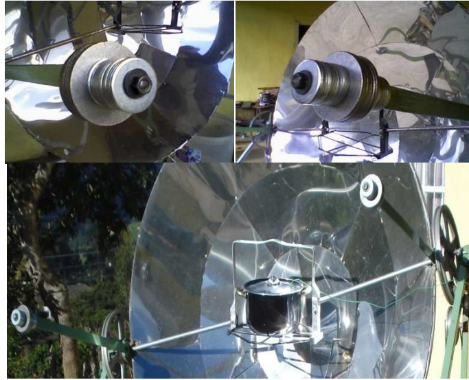
Figura 4.20: Montaje de contrapesos
