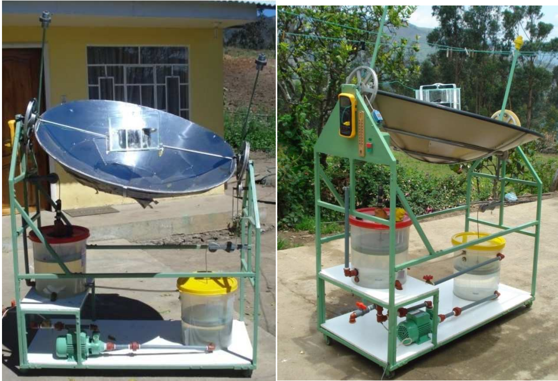
Figura 10.1: Equipo terminado (hidroseguidor solar con cocina parabólica)
