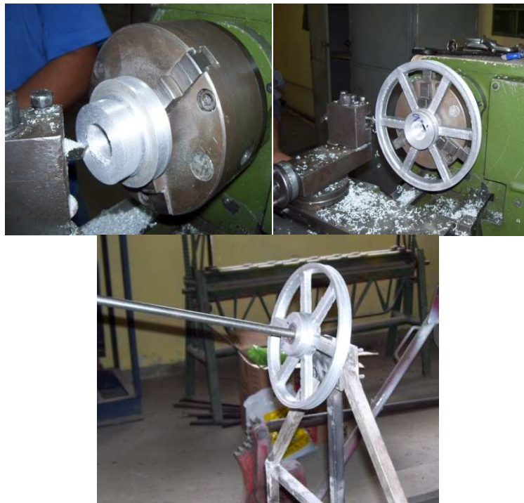
Figura 4.19: Construcción y montaje de poleas
