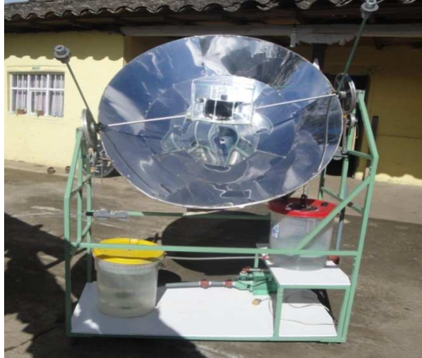
Figura 5.2: Equipo armado para la medición de temperatura, olla absorbente con el cobertor de vidrio
