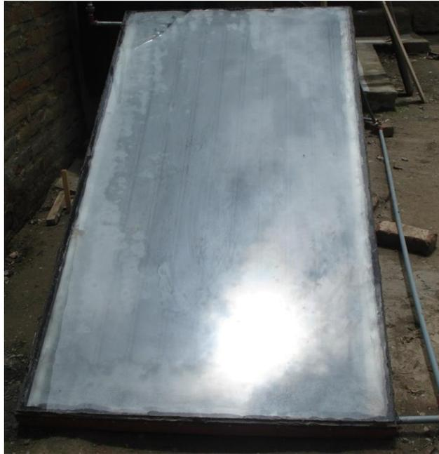
**Fig. 5.66. Colector plano construido**
