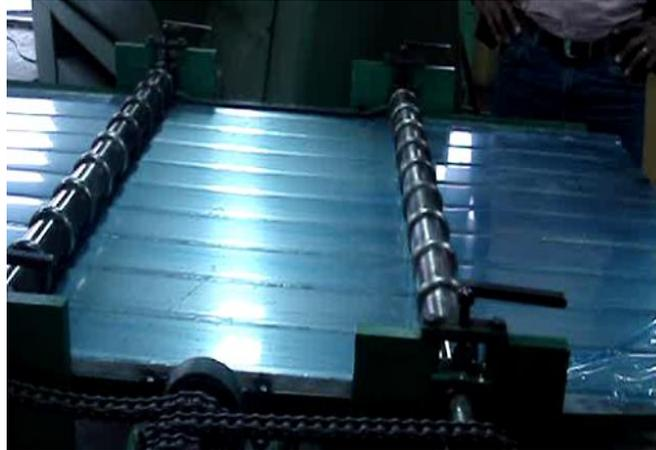
**Fig. 5.53. Plancha metida entre los rodillos**
