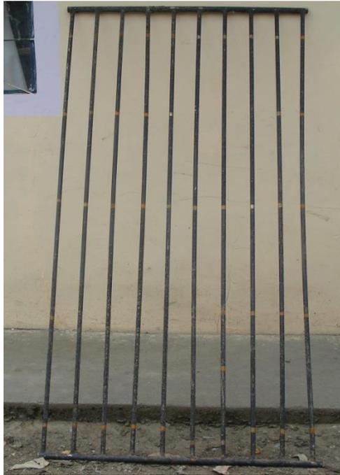
**Fig. 5.62. Tubos soldados para colector**
