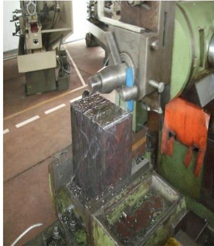
**Fig. 5.32. Nivelando en la cepilladora**
