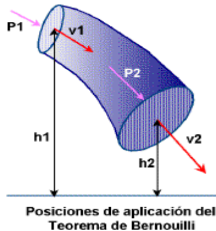
Figura 1.3. Explicación del teorema de Bernoulli
