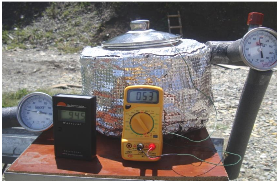
Fig. 20: Cocina a prueba, se observa la diferente instrumentación: Termómetros, Piranómetro, multímetro con opción de medidor de temperatura, termocupla tipo K.
