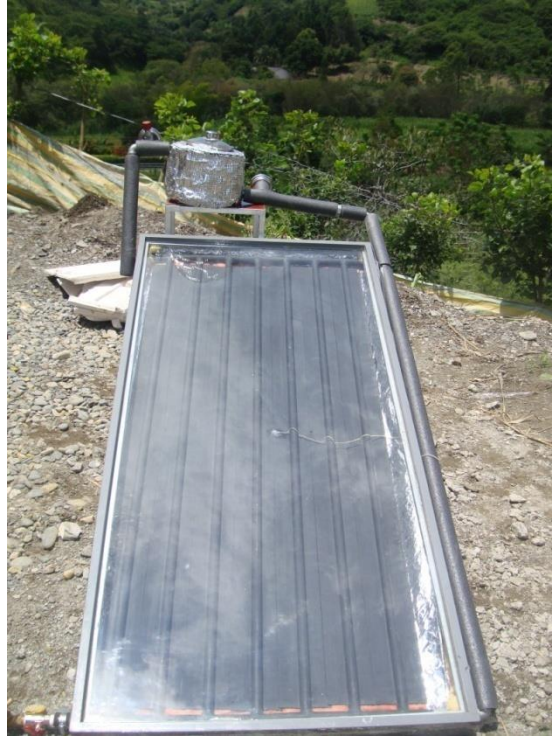
Fig. 21: Cocina solar de aceite térmico a prueba en el sector Landangui, Malacatos, Loja
