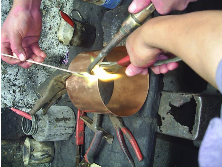
Fig. 17: Proceso de soldadura del interior de la chaqueta
