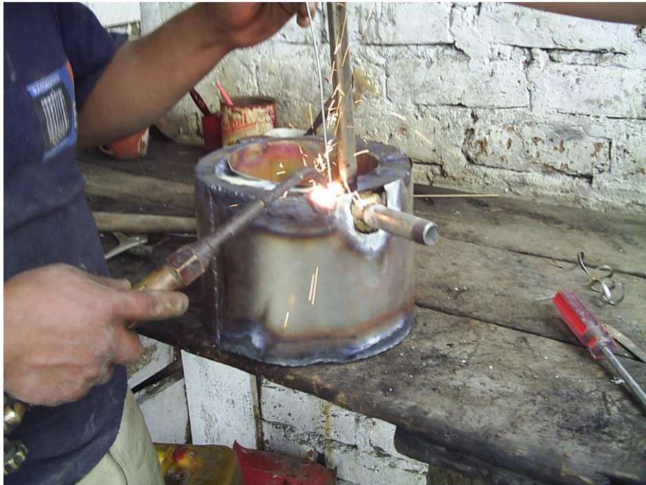
Fig. 18: Proceso de elaboración del intercambiador
