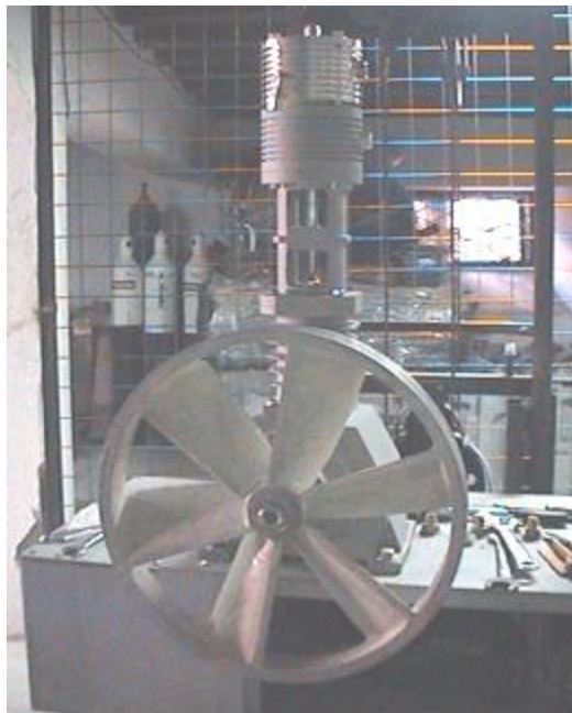
Figura 141. Compresor en proceso de montaje.
