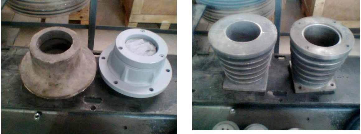
Figura 139. Algunas partes fundidas del compresor.
