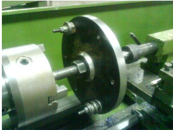
Fig. 1 Construcción de bridas en el torno
