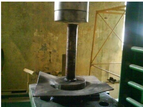
Fig. 3 Prensado del casquete esférico de la cámara de aire
