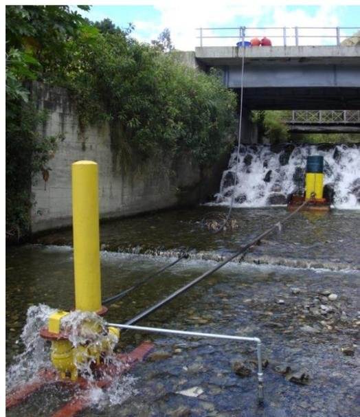
Fig. 5.16 Instalación experimental y funcionamiento del ariete de aguas bravas
