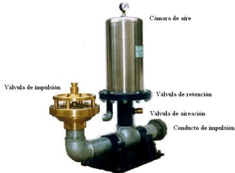
Fig. 1.1 Elementos componentes del ariete hidráulico
