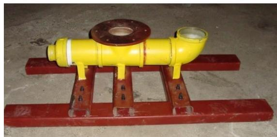
Fig. 8 Estructura base y cuerpo de ariete
