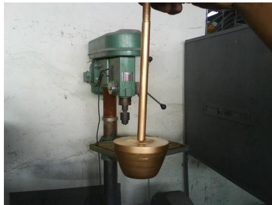
Fig. 5 Válvula de impulsión terminada
