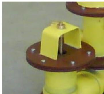
Fig. 10 Soporte de la válvula de impulsión
