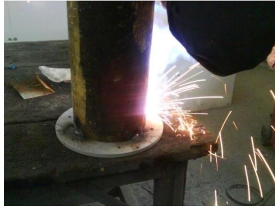
Fig. 4 Soldado de la brida a la cámara de aire
