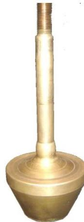
Fig. 1.5 Válvula de impulsión
