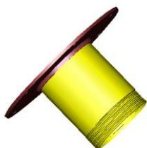
Sobre el codo se coloca el niple que contiene fija una brida, que se acopla con otra que contiene la base y el buje de la válvula, entre brida y brida se coloca un empaque de manera que no pérdidas de presión por fugas de agua, antes de acoplar
