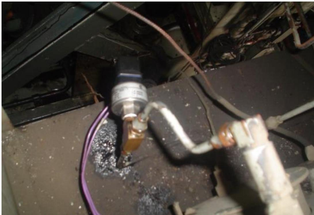
Montaje del sensor de presión en la cañería de entrada al manómetro
