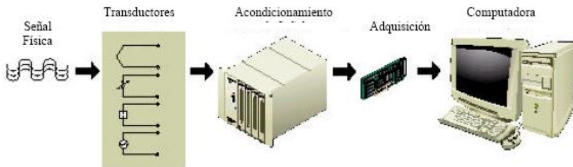
**Fig. 1.4 Configuración típica de una comunicación industrial**
