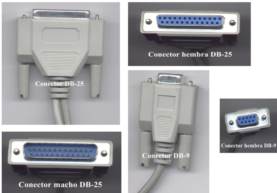
Fig 3.30 Distintos tipos de conectores DB para comunicación serial RS-232
