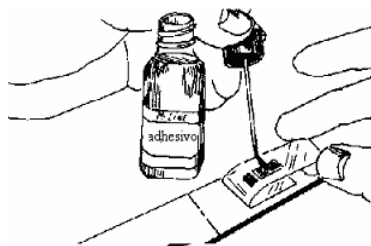
Fig. 2.8: Colocando el adhesivo
