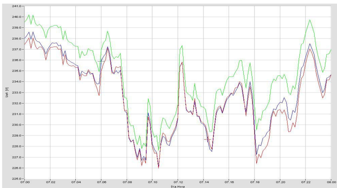
Fig. 3.2 Medida de secuencia temporal de voltaje en fases en transformador 100 KVA
