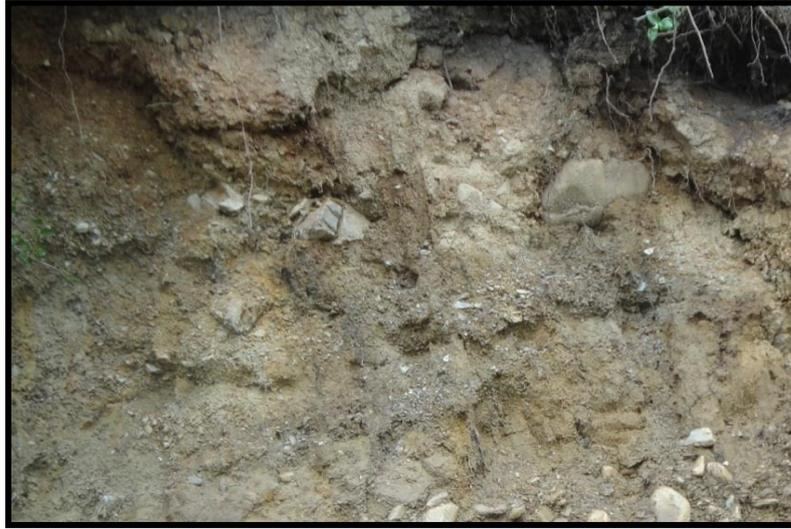
**Foto Nro. 4.** Suelo de coloración café amarillento, producto de la desintegración del conglomerado, localizado al Sur del sector de estudio.
