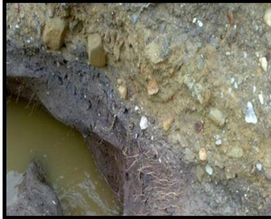
**Foto 27.** Muestra de Depósitos Coluviales aflorando en margen O de la zona de estudio
