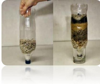
Filtración es un proceso en el cual partículas sólidas que se encuentran en un fluido líquido o también gaseoso se separan mediante un medio filtrante, o filtro, que permite el paso del fluido a su través, pero retiene las partículas sólidas. Unas veces. Interesa recoger el fluido; otras, las partículas sólidas y, en algunos casos, ambas cosas.
