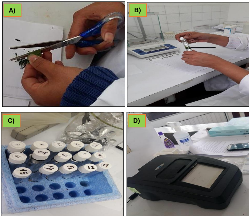
Figura 20. Extracción y lectura del contenido de clorofila en las hojas: A) corte de la lámina foliar sin nervadura; B) colocación de 0,5 g de muestra en etanol; C) tubos de ensayo previamente envueltos en papel aluminio; D) medición de la clorofila a y b en el espectrofotómetro.
