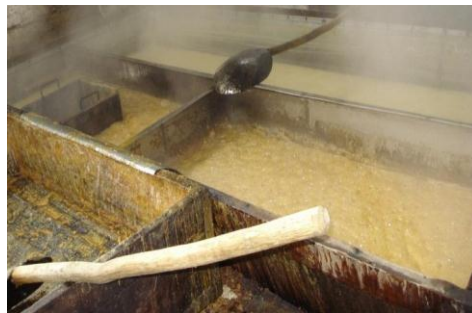
Foto 5. Evaporación y adición del antiespumante
