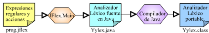
Ilustración 9. Obtención de un programa portable en java a partir de una especificación JFlex.
