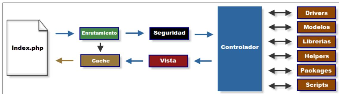
Figura 1. Diagrama de flujo CodeIgniter.
