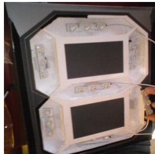
Figura 12: Cajas con 7 segmentos de tres leds en cada soporte
