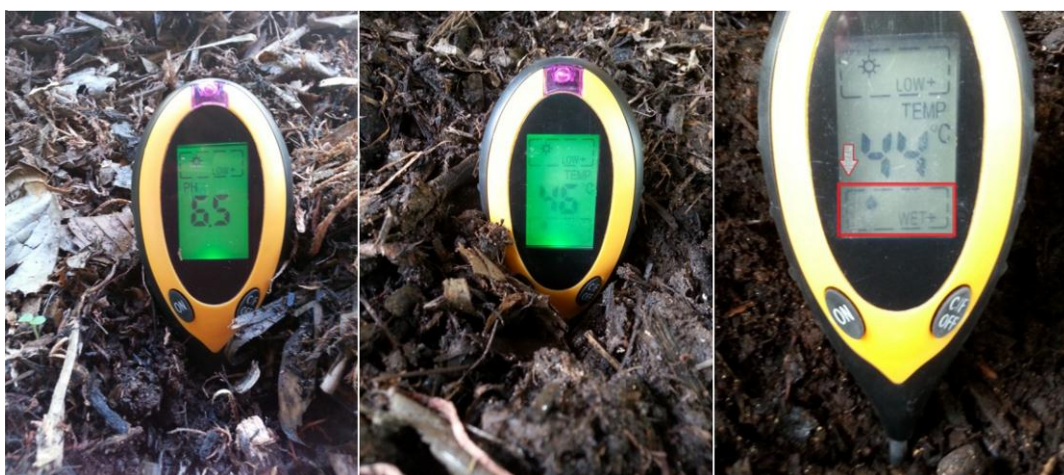
Fotografía 7: Registro de datos con Instrumento de estudio de suelos.
