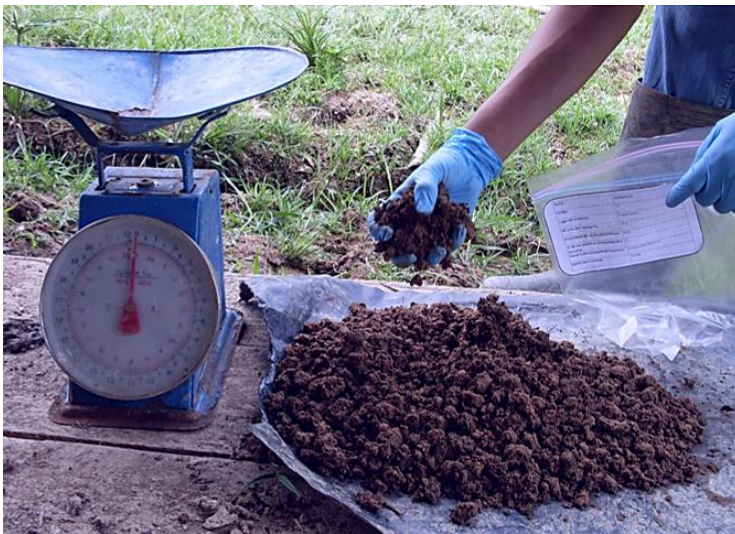
Fotografía 2: Pesado de la muestra de diagnóstico del suelo.
