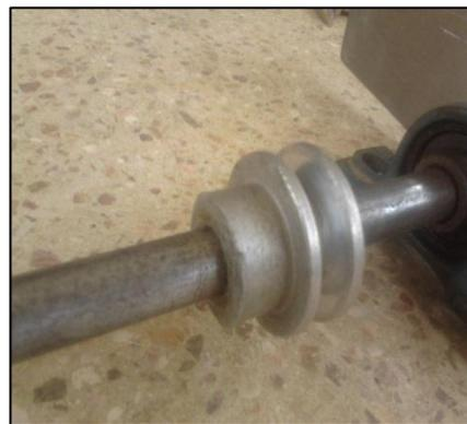
**Fotografía 35.** Acoplamiento eje.
