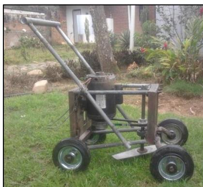
**Fotografía 41.** *Vista lateral de la máquina podadora para césped.*
