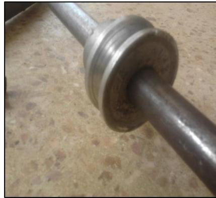
**Fotografía 29.** *Acoplamiento polea y eje.*
