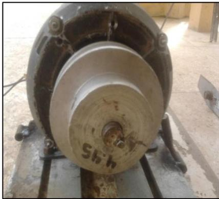
**Fotografía 28.** *Acoplamiento polea y motor.*
