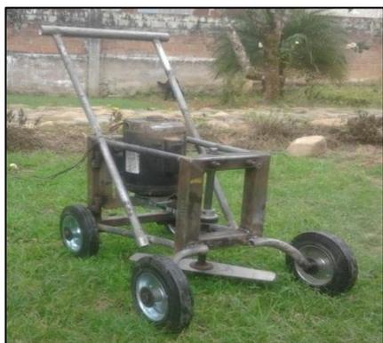
**Fotografía 40.** *Vista frontal-lateral de la máquina podadora para césped.*
