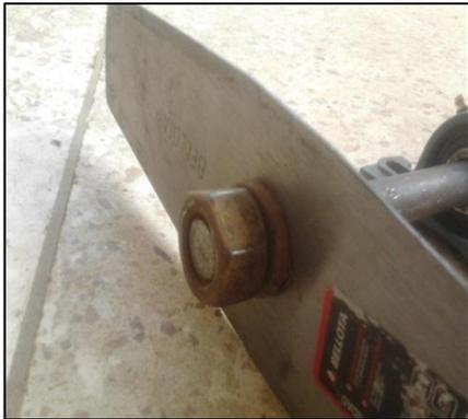
**Fotografía 36.** *Acoplamiento cuchilla.*
