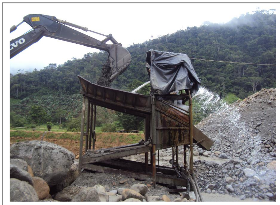
Foto 14. Colocación del material (subsuelo) en la tolva de la clasificadora tipo Z.
