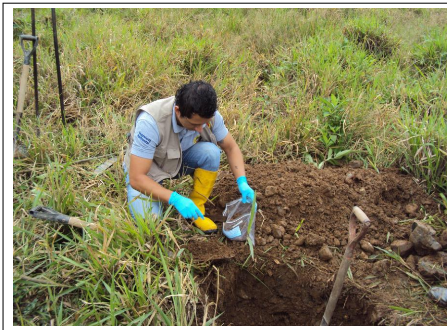
Foto 6. Separando manualmente fracciones gruesas como piedras, hiervas, otros.
