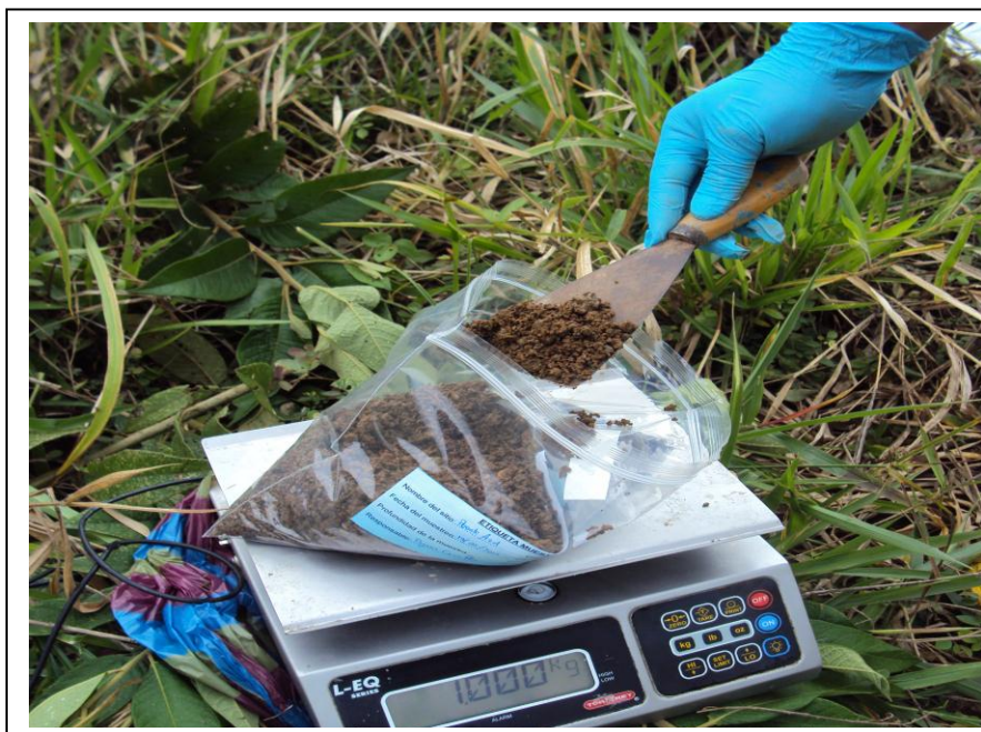
Foto 7. Pesado de muestras en su respectivo recipiente ya etiquetado.
