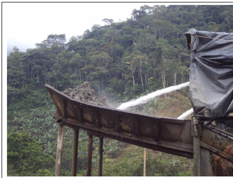
Foto 15. Lavado del material (subsuelo) a presión de agua.
