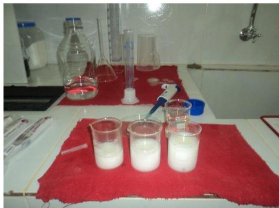
**Fotografía 10.** Dilución del GANABOL, en Etanol y Agua Bidestilada
