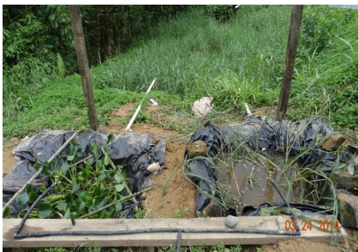
Fotografía 10. Sembrado de las respectivas plantas en cada piscina experimental construida
