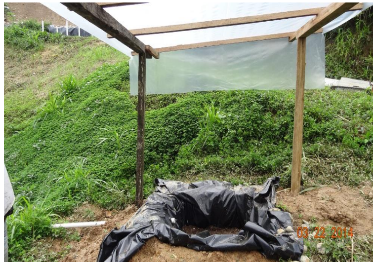
Fotografía 6. Colocación de una capa de tierra en cada una de las piscinas experimentales
