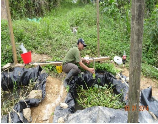
Fotografía 7. Regulación del caudal que ingreso a la piscina en el tiempo establecido
