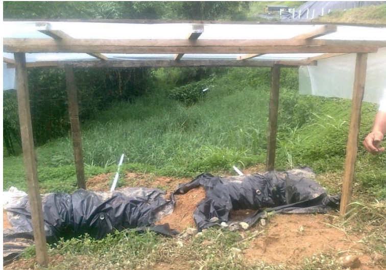
Fotografía 3. Colocación del plástico sobre las piscinas experimentales.
