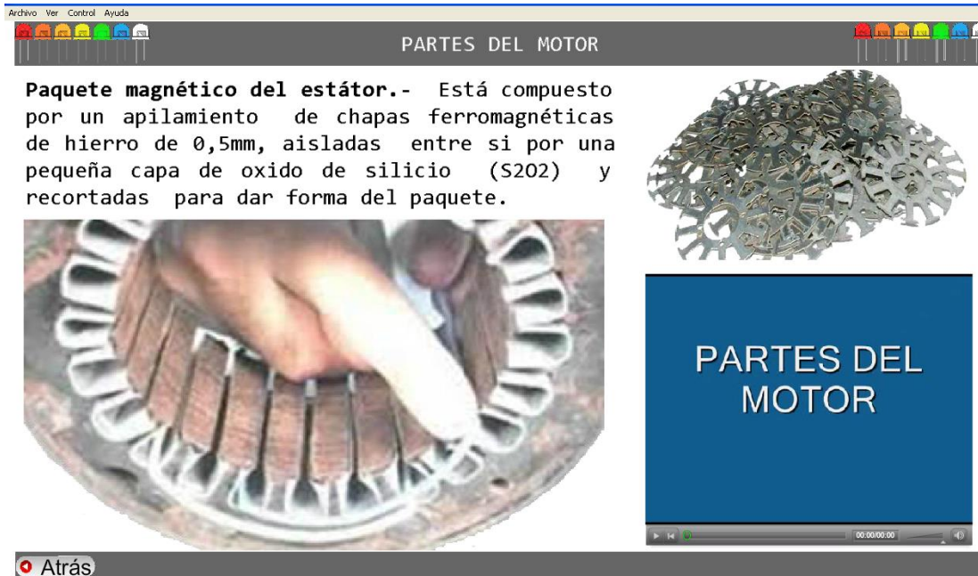
IMAGEN 4. Paquete Magnético de un motor
