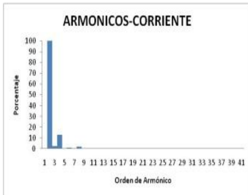
Figura 11.- Espectro armónico de la lámpara fluorescente de 20W
