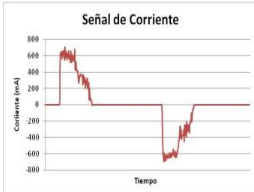
Figura 6.- Señal de corriente contaminada de un Foco ahorrador de 20W
