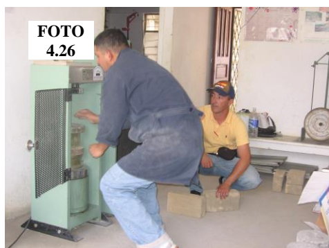
Foto 4.26: Se calibra máquina de compresión, se mide y pesa cada uno de los adobes.
