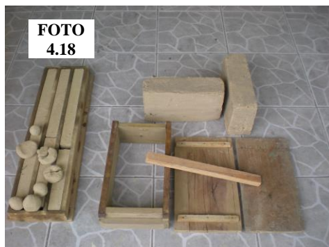
Foto 4.18: Equipo o fábrica artesanal para moldear adobe.
