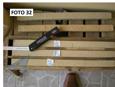
Foto 2.31: Inicio de ensayo el 19-02-2010 con (6, 8, 10) % cemento.
