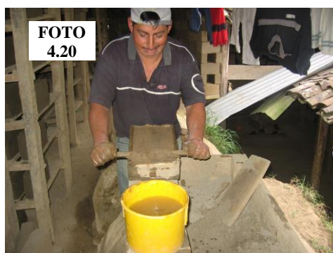
Foto 4.20: Enrazado y nivelado final del adobe
