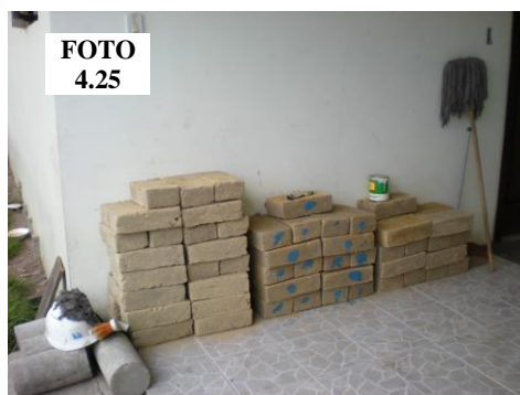
Foto 4.24: Adobe en laboratorio momentos antes de ser sometidos a compresión simple.
