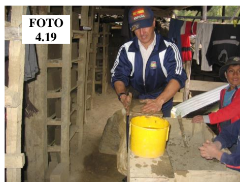
Foto 4.19: Moldeado manual de un adobe mediante proceso artesanal.
