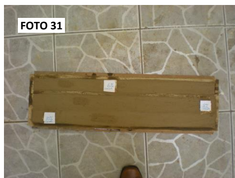
Foto 2.31: Inicio de ensayo el 19-02-2010 con (6, 8, 10) % cemento.
