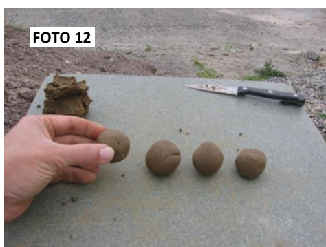
Foto 2.12: Muestras preparadas para secado.
