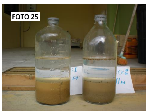
Foto 2.25: Hidrómetro realizado a suelos con valoración previa.
