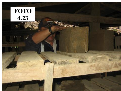
Foto 4.23: Tendal: lugar de secado al ambiente donde se marca cada uno de los especímenes de acuerdo con su contenido de cemento.
