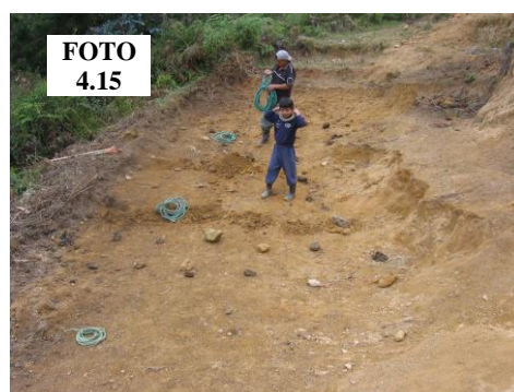
Foto 4.14 y foto 4.15: Recolectión de la muestra: para ensayos de campo, laboratorio y 200 adobes para compresión simple e intemperismo.
