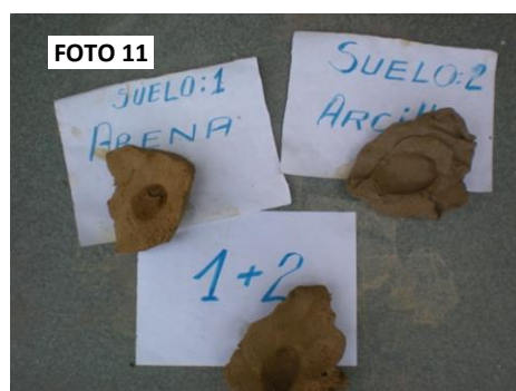
Foto 2.11 Ensayo de golpes.
