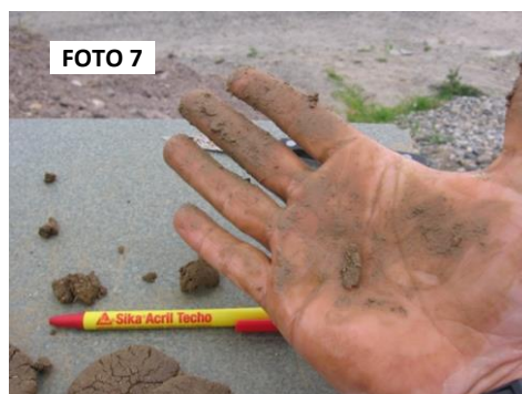
Foto 2.7: Suelo se pega parcialmente en la palma al manipularlo.
