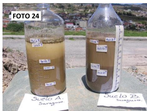
Foto 2.24: Hidrómetro realizado a suelos sin valoración previa
