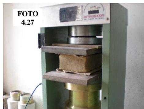
Foto 4.26: Se calibra máquina de compresión, se mide y pesa cada uno de los adobes.
