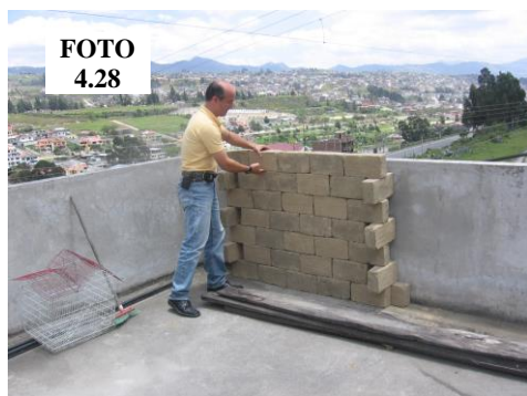
Foto 4.28: Muro de adobe que presenta inestabilidad frente al viento.
