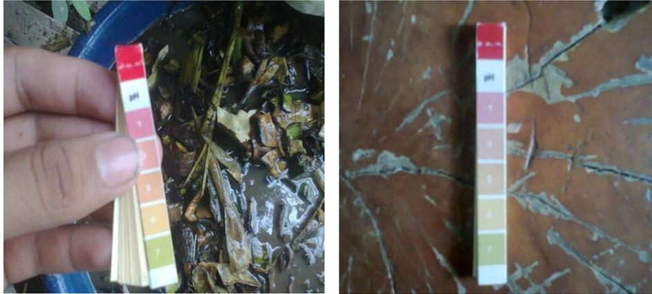
Cinta de Potencial de Hidrógeno (pH).
