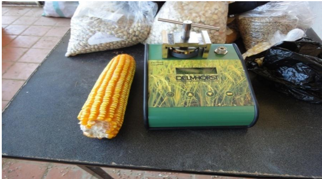
Figura 46: Medidor de humedad G-7.
