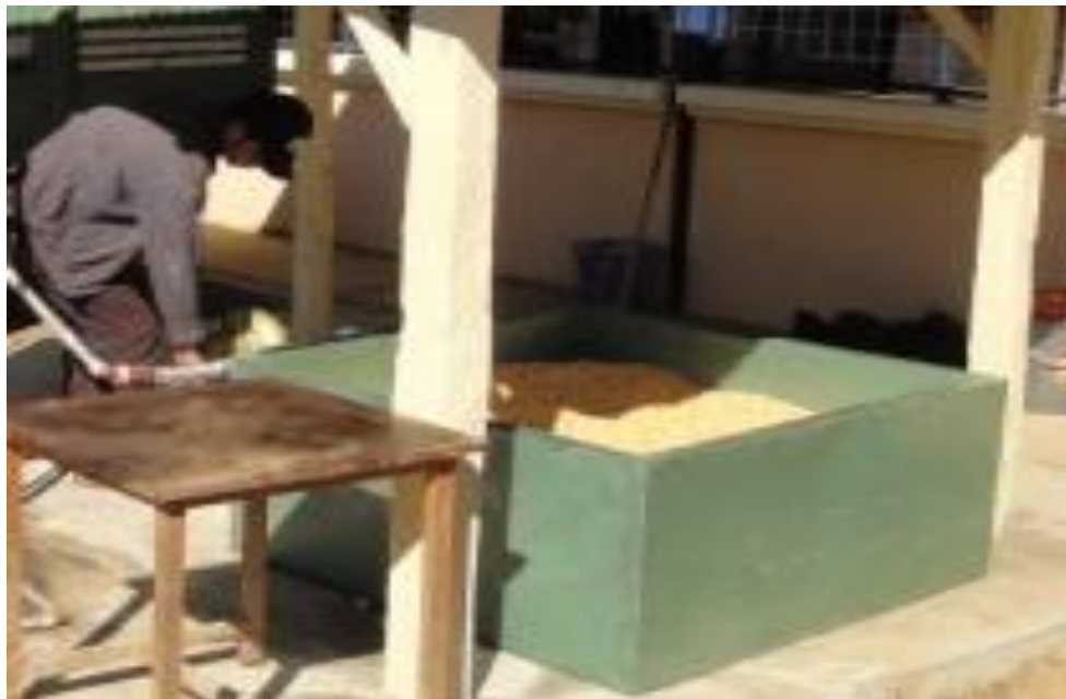
Figura 15: Silo del secador solar de maíz y maní.
