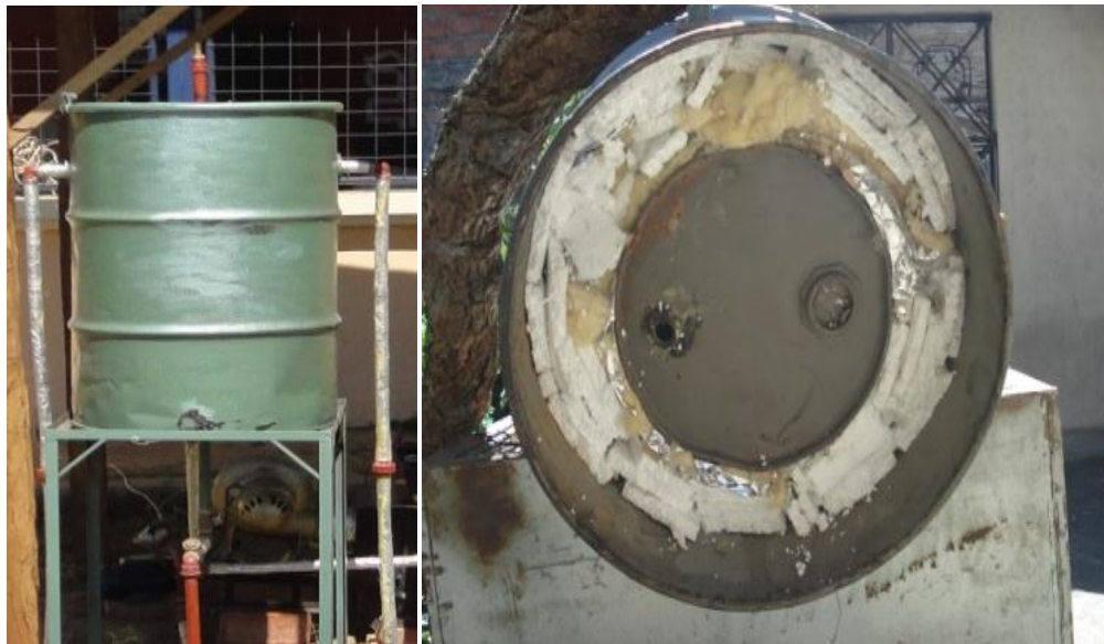
Figura 8: Tanque de reserva del secador solar de maíz y maní.
