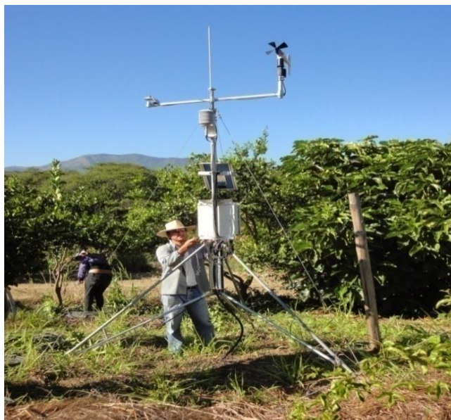
Figura 44: Instalación de la estación meteorológica en el Centro Binacional de Formación Técnica Zapotepamba.
