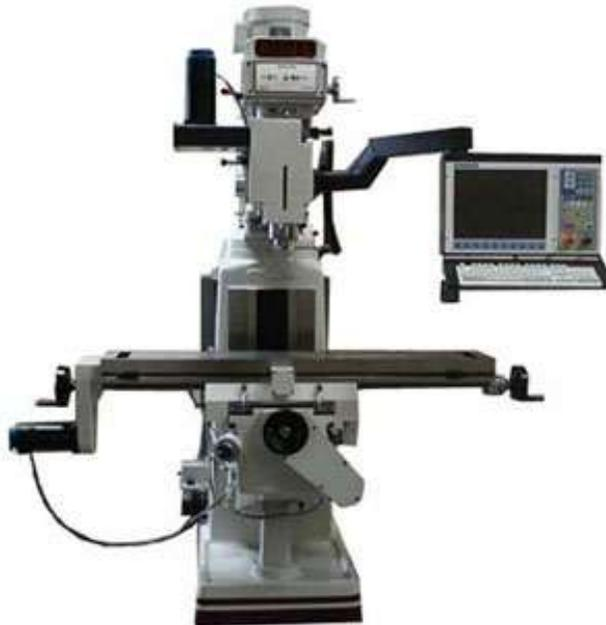
Figura 6: (Fresadora CNC con mando computarizado)
