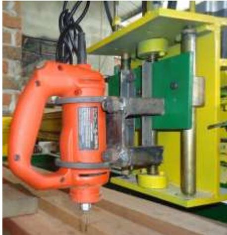
Figura 34: Sistema de soporte para fresadora
