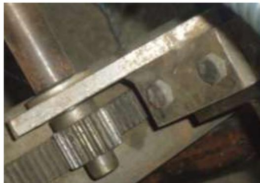
Figura 53: Soporte Unión para la barra de transmisión
