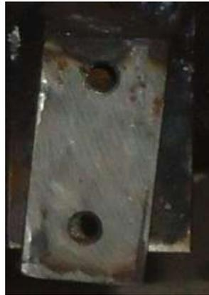
Figura 48: Soporte para los extremos de la barra de transmisión
