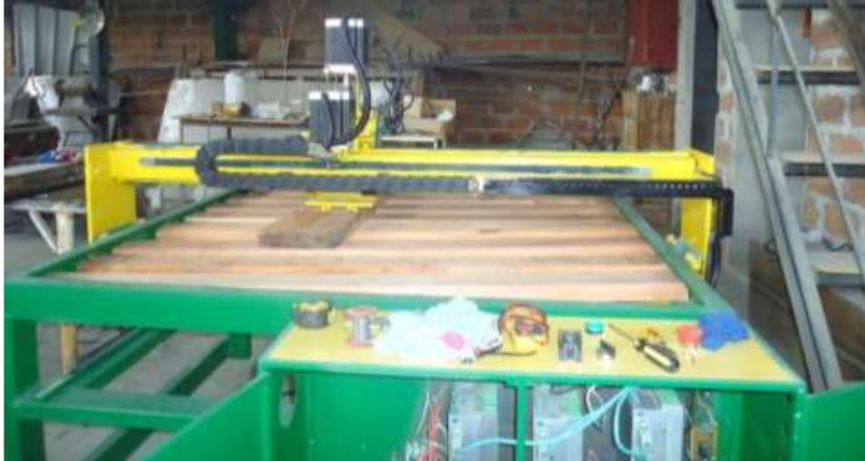
Figura 28: Fresadora CNC para piezas de madera
