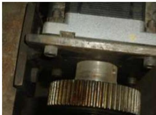
Figura 46: Soporte para el motor del eje X
