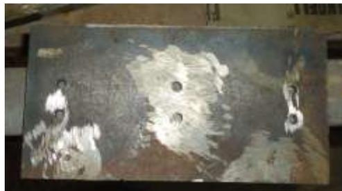
Figura 50: Base principal para fresadora
