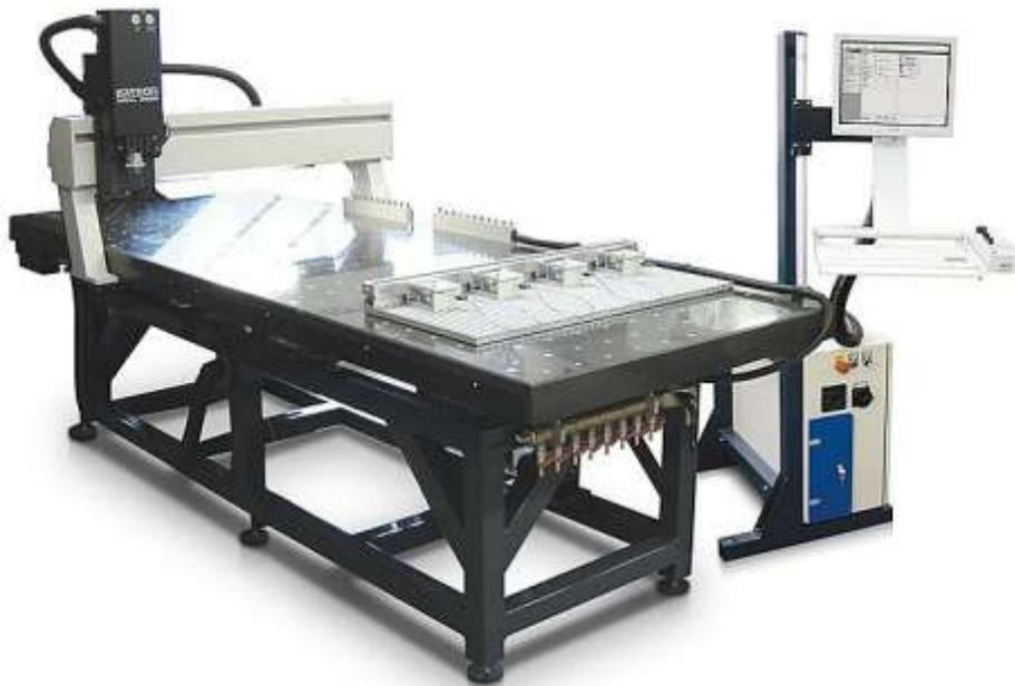
Fig. 10.1: Prototipo de la Fresadora CNC para Madera
