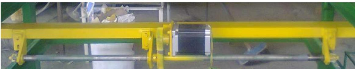
Figura 36: Soporte con rulimanes para los extremos de eje
