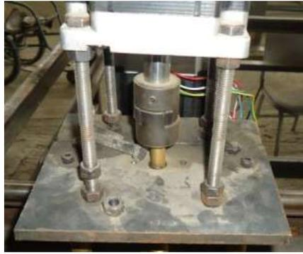
Figura 47: Base del motor para el eje Z
