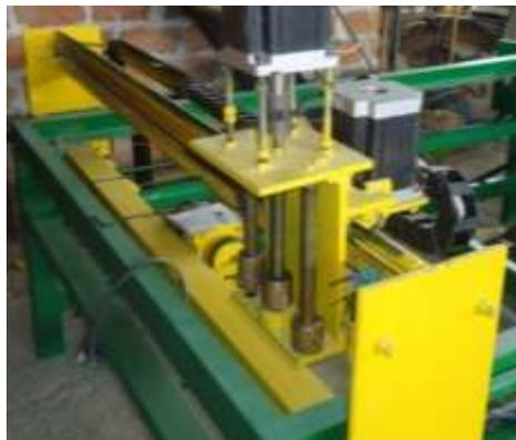
Figura 31: Carro de eje Y
