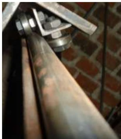
Figura 37: Guías del eje Y.
