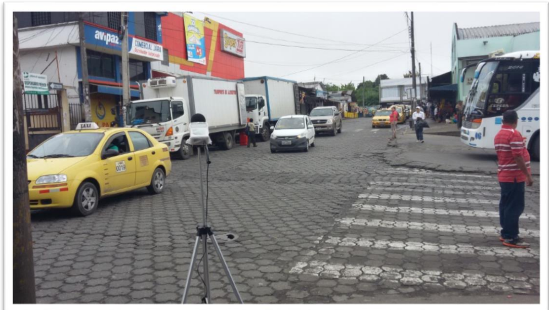
Medición de ruido vehicular entre las 12H00 y 14H00 Calle Guamote / 10 de Agosto Sector el Tía.
