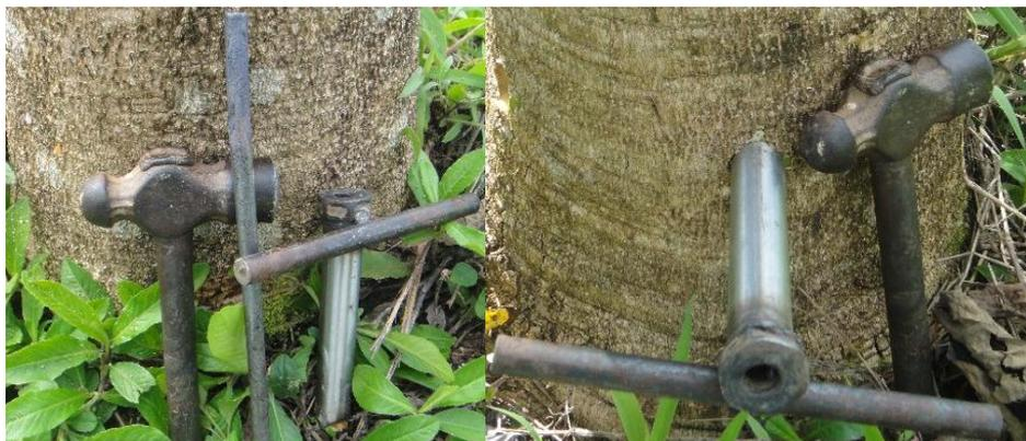
Figura 3. Barreno utilizado en la extracción de muestras.
