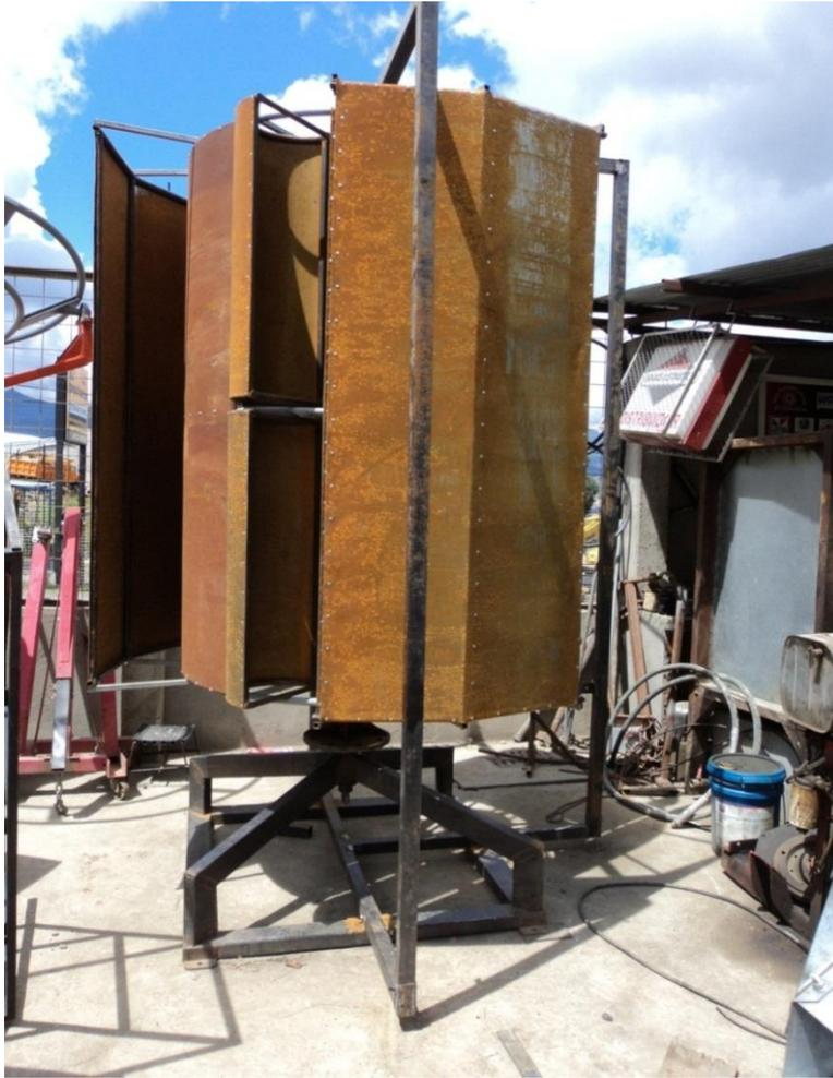
Aerogenerador de eje vertical
