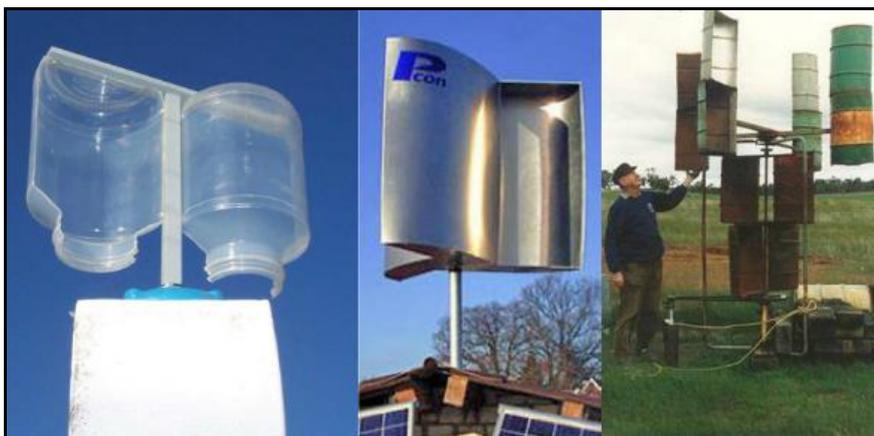
*Fig. 3: Diferentes modelos de rotor de eje vertical tipo Savonius*
