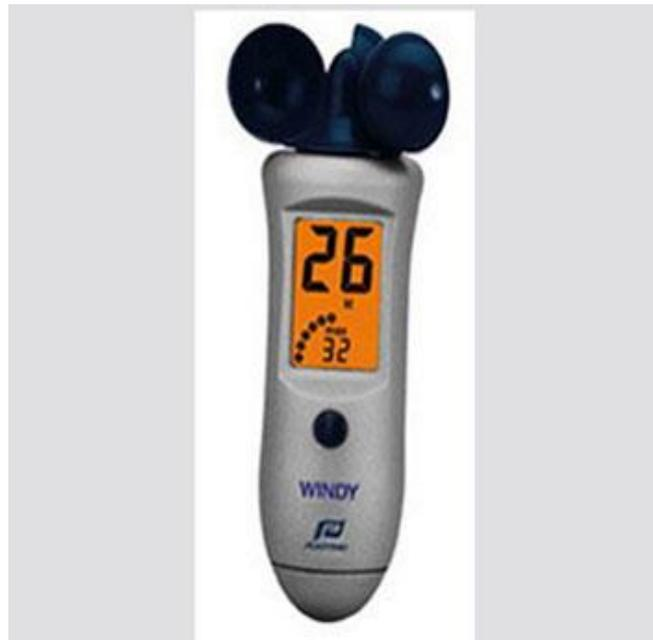
*Fig. 8: Anemómetro digital*
