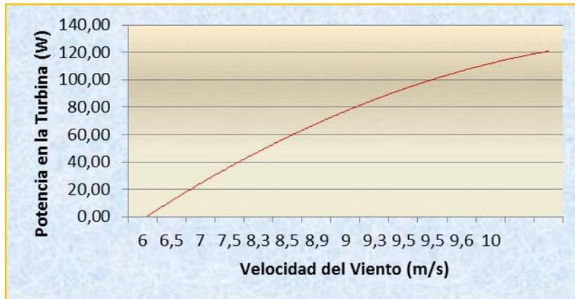
*Fig. 44: Relación de la potencia con respecto a la velocidad del viento*
