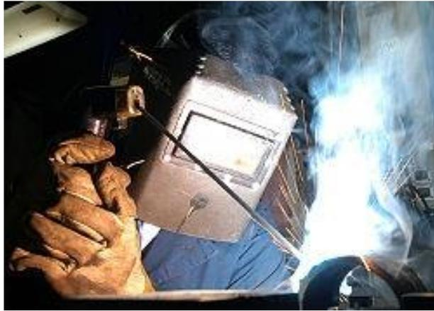
*Fig. 10: Soldadura por Arco eléctrico*
