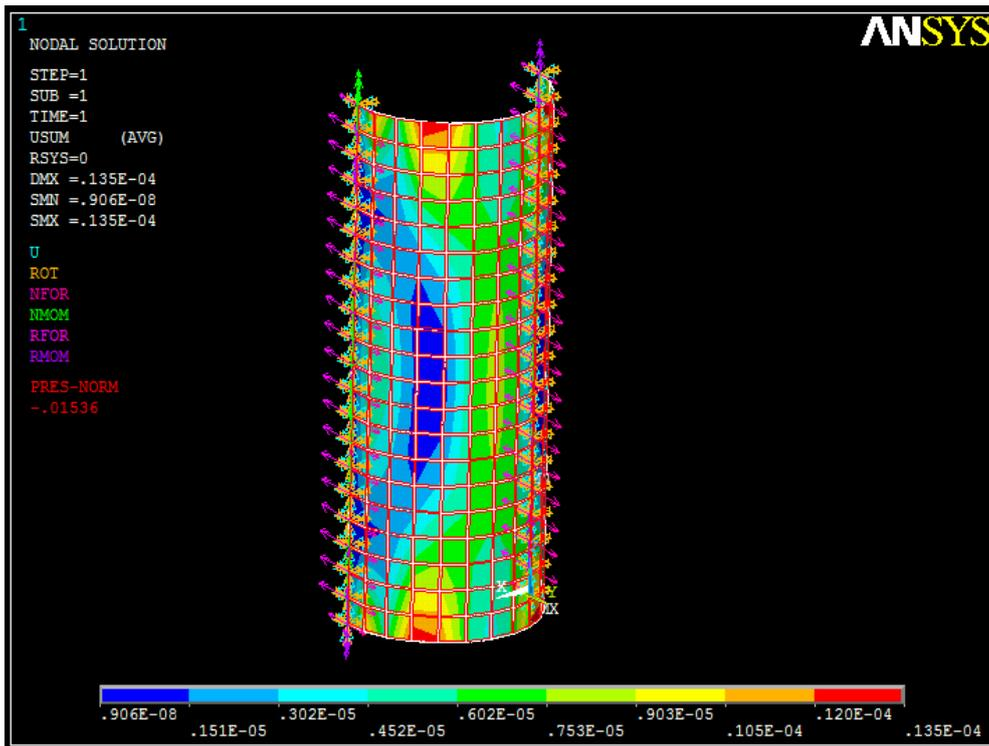
Fig. 20: Deformación de aspas sometidas a carga, (Vista de posterior, unidades en cm)
