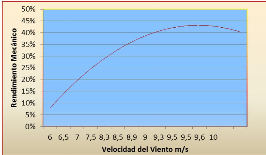
*Fig. 43: Rendimiento mecánico en el eje de la Turbina*
