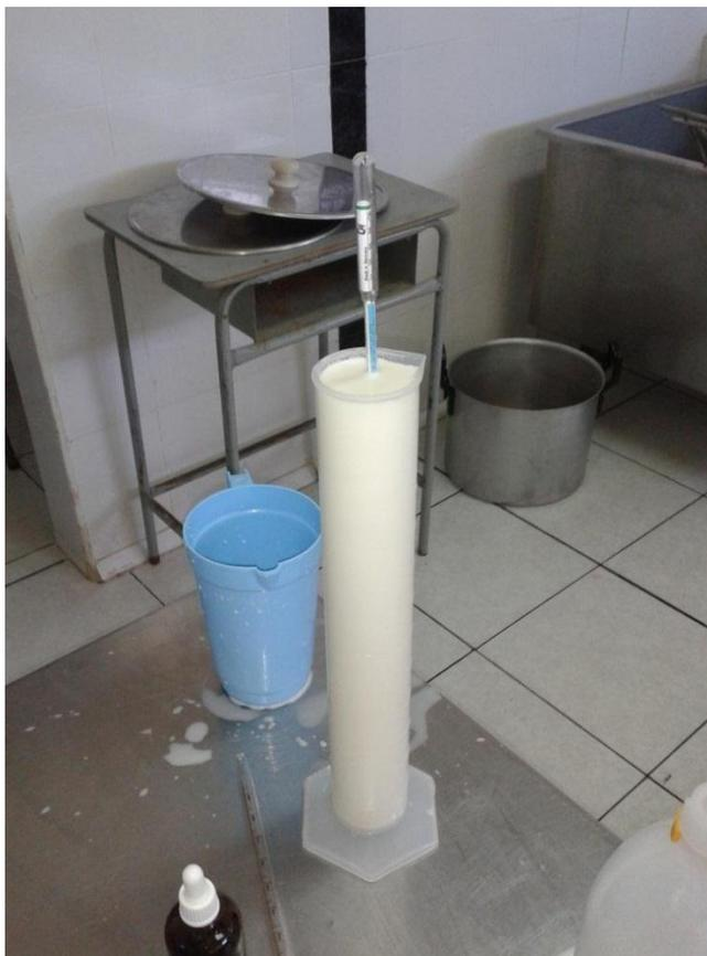
**Foto 7:** Verificación de la densidad de la leche mediante el termolactodensímetro
