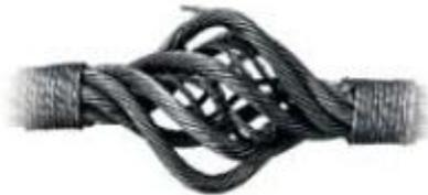
Desgaste de un toron antes de los torones adyacentes debido a una colocación de una fijación incorrecta
