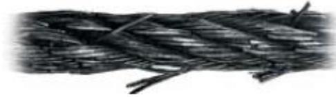
Cable sujeto a Melladuras: Rozamiento producido por rozamiento de los torones, si bien esto es por un funcionamiento normal también se producen por cargas altas en poleas pequeñas
