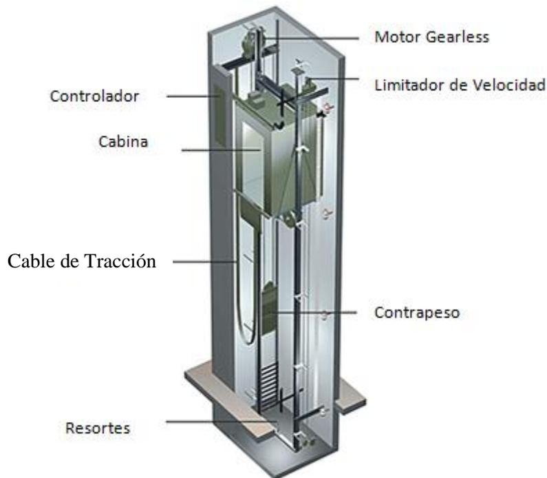
Figura 3 Instalación típica de un ascensor sin cuarto de máquinas
