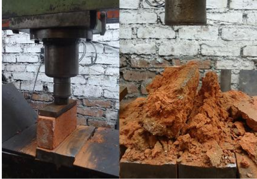
Foto 10: Resistencia a la compresión ladrillo Máquina posición de filo, resultado 23Kg/cm^2
