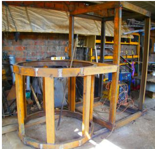
Foto 13: Estructura, máquina compactadora de ladrillos
