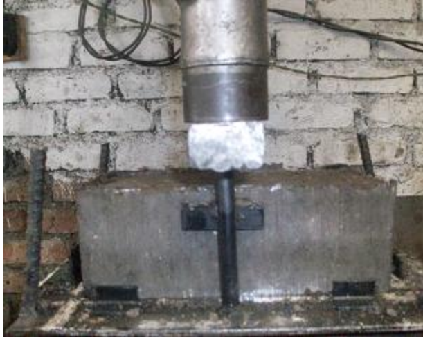
Foto 6: Ladrillo compactado en prototipo.
