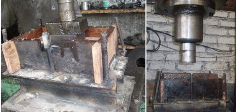
Foto 5: Compactación de ladrillo en prototipo.
