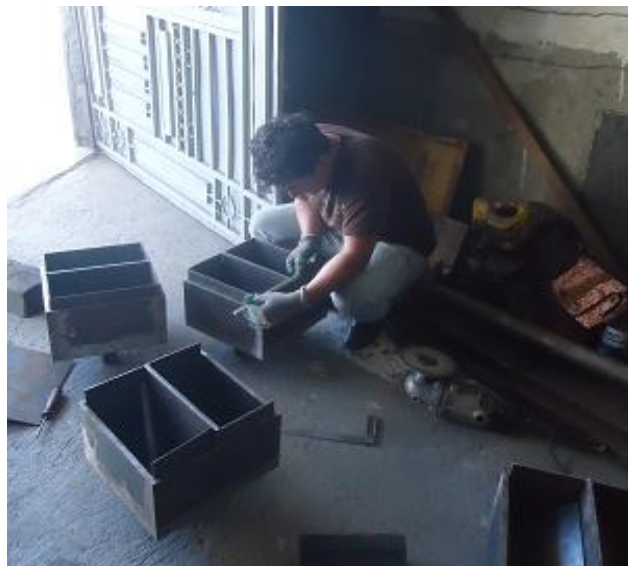
Foto 15: Moldes y divisor de la máquina compactadora
