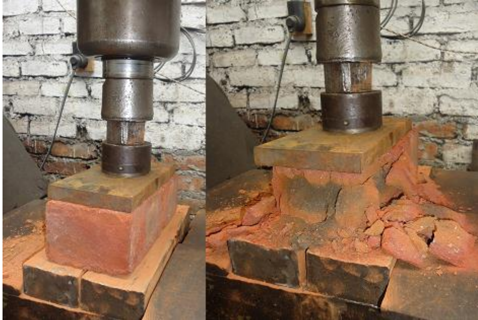
Foto 12: Resistencia a la compresión ladrillo Máquina posición de tendido, resultado 43Kg/cm^2
