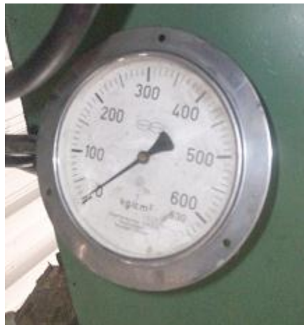
Foto 5: Medida presión de compactación.
