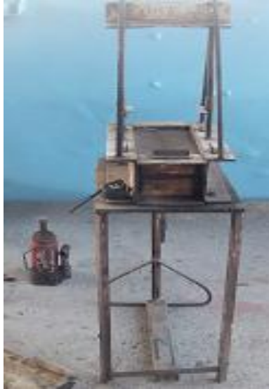
Foto 1: Prototipo de Molde para ladrillo.
