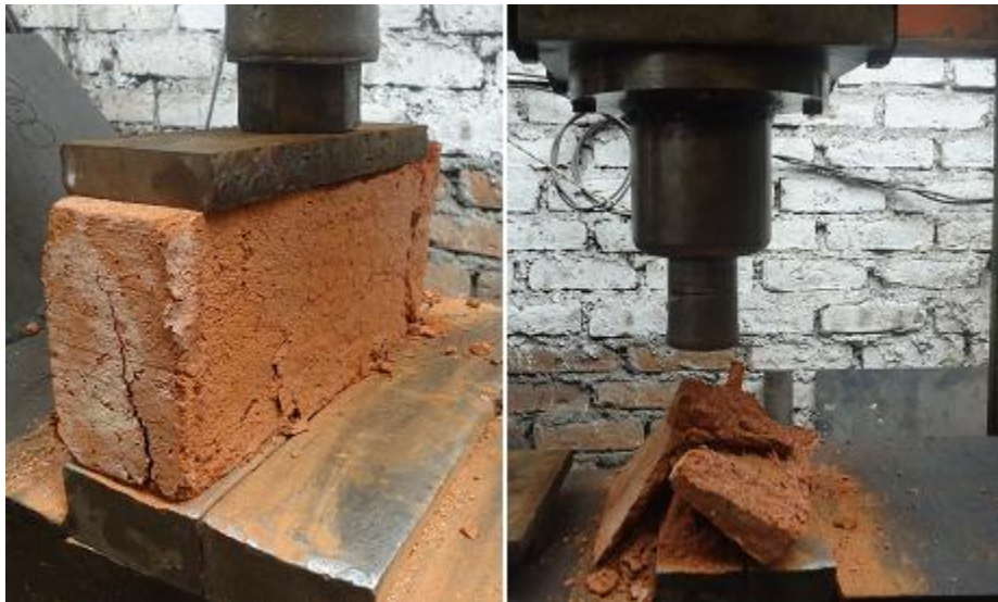
Foto 9: Resistencia a la compresión ladrillo Artesanal posición de filo, resultado 12Kg/cm^2
