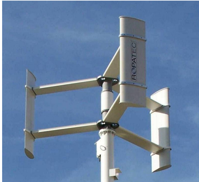
Figura 23. Sistema de Conversión de Energía Eólica de Eje Vertical.
