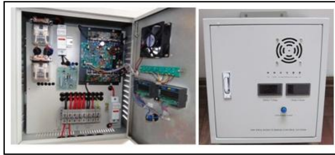
Figura 45. Vista interior y exterior del equipo controlador de carga y descarga seleccionado.
