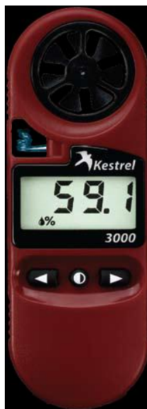
Figura 31. Anemómetro utilizado en la fase de rendimiento del equipo instalado.
