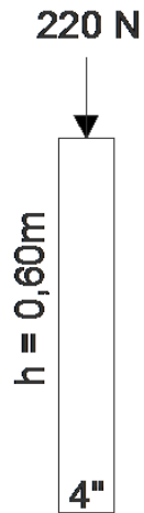
Figura 45 diagrama de fuerzas que actúan en el mástil
