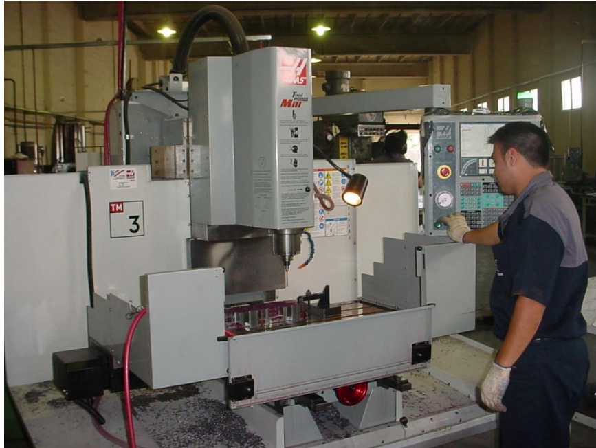
Figura 45. Fresadora CNC realizando el mecanizado de una pieza. Fuente: wikipedia.org
