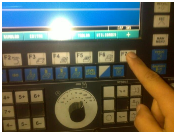
Figura 309. Insertar posición actual de cambiador
