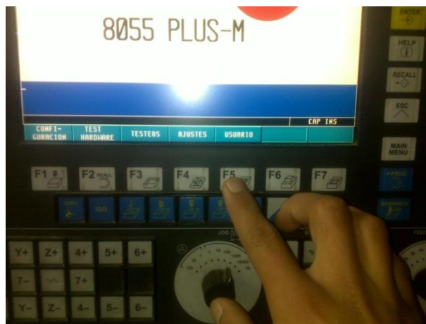
Figura 310. Insertar posición actual de cambiador
