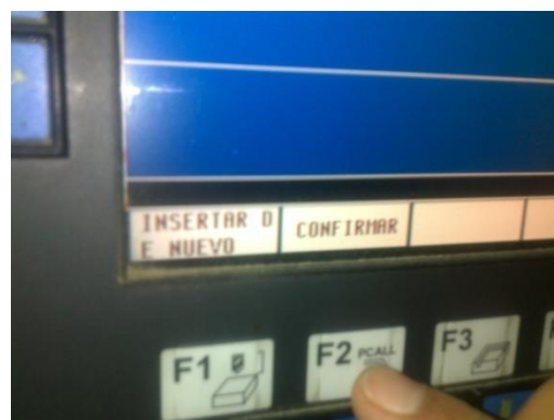
Figura 317. Insertar posición actual de cambiador
