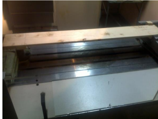
Figura 372. Giro del material en bruto y ejecución del mecanizado de la parte inferior del modelo
