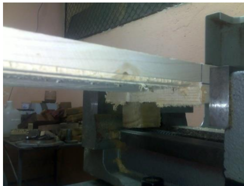
Figura 374. Giro del material en bruto y ejecución del mecanizado de la parte inferior del modelo
