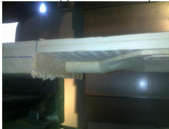
Figura 373. Giro del material en bruto y ejecución del mecanizado de la parte inferior del modelo
